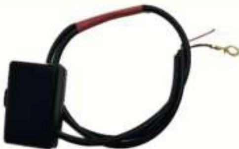
Hidrolik Kumanda devresi traktörlerde hidrolik sistemi harekete geçirilmesi için kullanılan bir ürünüdür. İkaz alındığça 6 saniyede 40 impuls üretir ve çıkışını + potansiyele çekerek maksimum 600 miliamperlik bir yükü elektriksel olarak harekete geçirir. Ürün 12 Volt olarak tasarlanmıştır.
