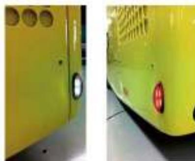
Ürün ledli olup az akım çeker. İz lambası olarak tampon üzerinde kullanılır. Sürücü tarafından dikiz aynasından bakıldığından , aracın alt ve üst kısımlarının işaretlenmesine yaramaktadır.
