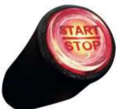
Motorun tetiklenip çalıştırmasını sağlayan anahtardır. Bas çek türü çalışır, motora tektik verdikten sonra, bir sonraki tetik için yerine döner. Mekanizma manyetik olarak read relay tetiklemesi ile çalışır. Düğmenin zeminin de sürekli yanık kalan yeşil LED aydınlatma sayesin de kontağın açık olduğunu gösterir.
